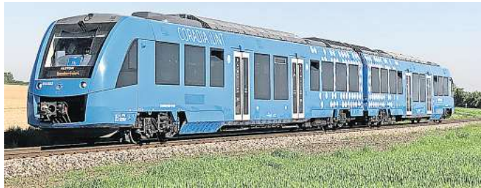
Ein „Coradia iLint“: Gebaut wird der mit Wasserstoff betriebene Zug in Salzgitter.
