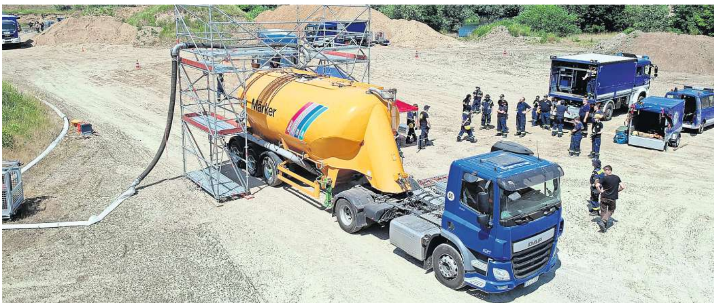
Aufbau der Wasserförderung aus dem offenen Gewässer über ein Gerüstsystem zum Befüllen eines 30.000 Liter fassenden Silo-Anhängers.
