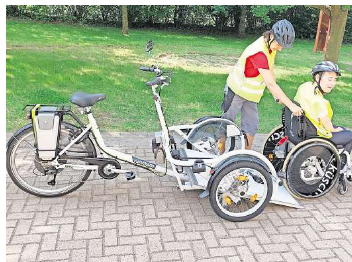
Die neue E-Bike-Konstruktion im Einsatz: CJD-Mitarbeiterin Andraea Maletz zieht Jeanette Pracht in ihrem Rollstuhl per elektrischer Seilwinde auf die Plattform.
