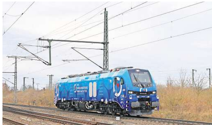
Neu im Fuhrpark: Die Hybrid-Mehrsystemlokomotive für Elektro- und Dieselbetrieb kann auf elektrifizierten sowie nicht elektrifizierten Strecken fahren.
