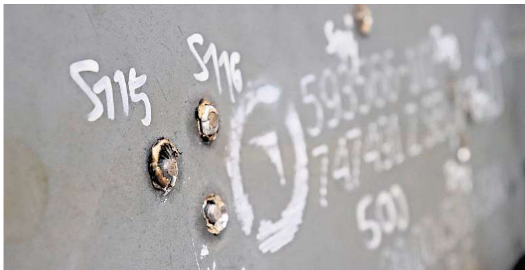
Hält den Patronen stand: Der Stahl Secure 500 durchlief das intensive Prüfverfahren der TL-Zulassung.
