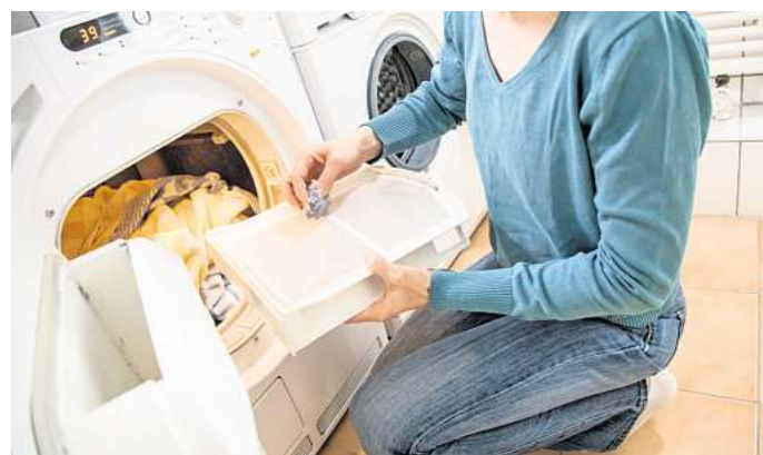
Flusen entfernen für Effizienz: Verstopfte Flusensiebe verlängern die Trockenzeit und erhöhen die Stromkosten und sollten am besten nach jedem Trockengang gereinigt werden. FOTO: CHRISTIN KLOSE
