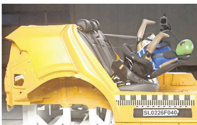
Sicherheitsrisiko im Crashtest: Acht Kindersitze zeigten gravierende Mängel und versagten im Frontalaufprall. FOTO: STIFTUNG WARENTEST
