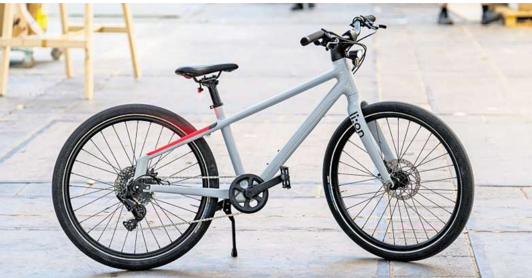
Das Modell «Light 24» vom Hersteller Li:on hat einen Rahmen aus Polyamid und recycelten Carbonfasern und kann durch einen dreistufig verstellbaren Steuersatz «mitwachsen».
