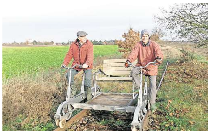
Probefahrt mit der frisch überholten Patria Fahrraddraisine: Die überholten Gangschaltungen und neuen Reifen funktionieren wieder tadellos.
