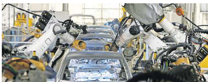
Schon heute gibt es bei vielen Firmen einen hohen Automatisierungsgrad durch Roboter, wie hier im Karosseriebau bei Volkswagen.
