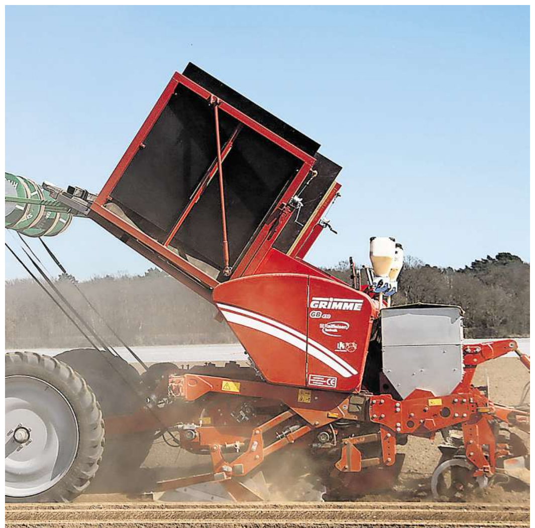
Hinrich Hornbostel und Hagen Meyer nutzen eine Pflanzmaschine, um die perforierten Schläuche Anfang April in die Dämme zu verlegen.
