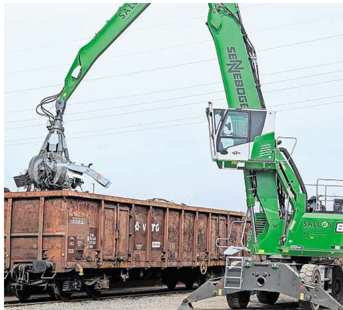
Aus Schrott für Schrott: Der Umschlagbagger aus grünem Stahl aus Peine wird auf dem Schrottplatz der Deumu in Salzgitter eingesetzt. Er hebt auch problemlos Autowracks. FOTO: DEUMU
