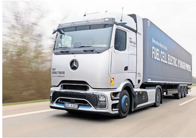
Große Reichweite für schwere Lasten: Daimlers NextGenH2-Truck fährt mit Wasserstoff statt Diesel und schafft mit vollen Tanks bis zu 1.000 Kilometer am Stück.
