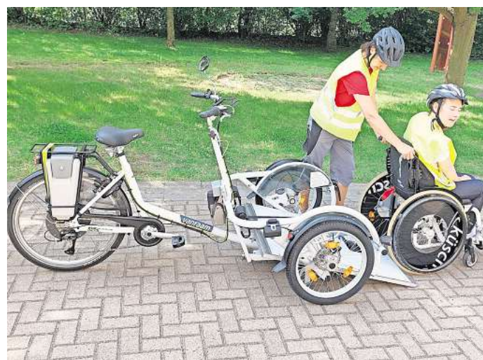
Die neue E-Bike-Konstruktion im Einsatz: CJD-Mitarbeiterin Andra Maletz zieht Jeanette Pracht in ihrem Rollstuhl per elektrischer Seilwinde auf die Plattform.
