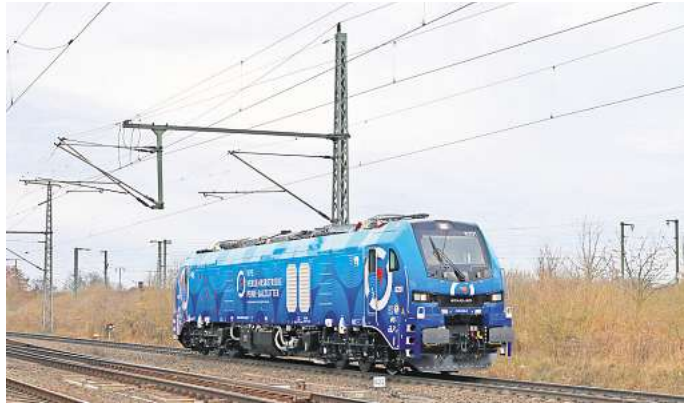
Neu im Fuhrpark: Die Hybrid-Mehrsystemlokomotive für Elektro- und Dieselbetrieb kann auf elektrifizierten sowie nicht elektrifizierten Strecken fahren.
