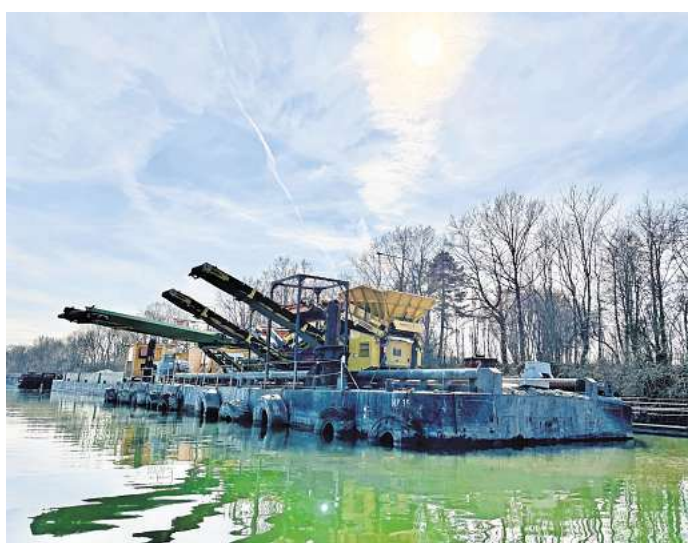
Einsatz auf dem Stichkanal: Eine Separationsanlage soll im unteren Vorhafen der Schleuse Üfingen das Baggermaterial auf Kleinmunition untersuchen. FOTO: WASSERSTRABEN-NEUBAUAMT HELMSTEDT
