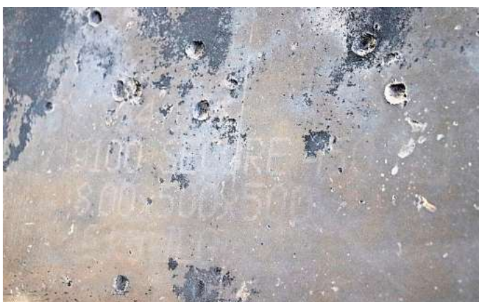
Zugelassen für das Militär: Die Einschusslöcher auf der SECURE-450-Platte sind nicht zu übersehen. FOTO: PRIVAT
