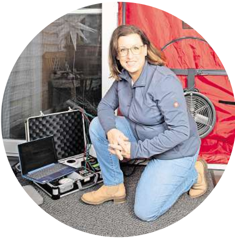
Der sogenannte Blower-Door-Test ist eine zentrale Vorgabe des Gebäudeenergiegesetzes. Mithilfe eines speziellen Gebläses lassen sich Undichtigkeiten gezielt lokalisieren und beheben.
