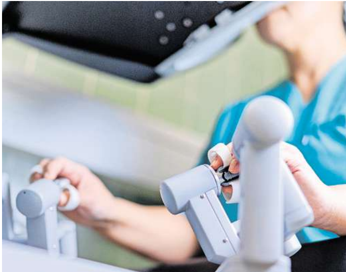
Beim Info-Tag wird der neue OP-Roboter des Klinikums vorgestellt, dessen Arme von speziell ausgebildeten Chirurgen von einer Konsole aus mit Fingern sowie über Pedale gesteuert werden.
