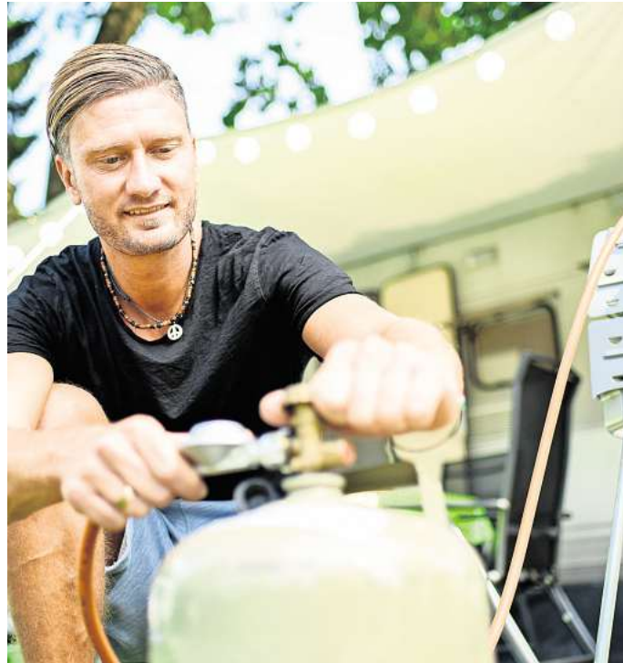
Bevor gebrutzelt wird, erst der Sicherheitscheck: Vor dem Angrillen Schlauch, Druckregler und Ventile prüfen – bei Rissen oder Porosität sofort tauschen.
