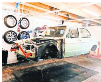
Gut zu sehen: Der vordere Kotflügel musste erneuert werden.
